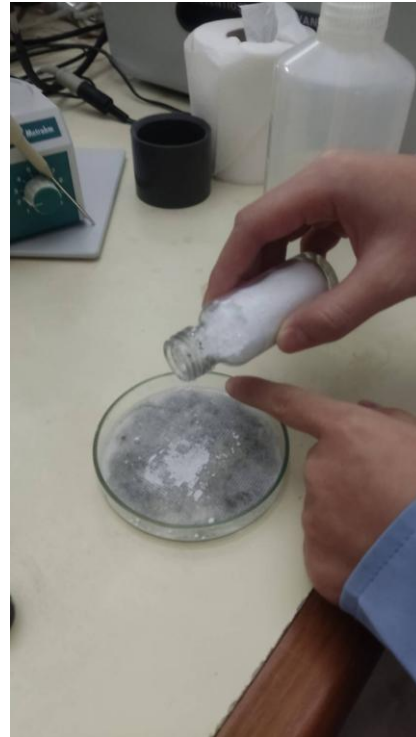
3. เทผงขัดเล็กน้อยใส่จานขัด
